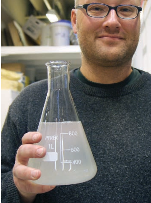
Claus Pade med cirka en liter VMA – nok til justering af to kubikmeter for flydende SCC.
