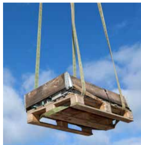
Så galt kan det gå. En palle – løftet med stropper – ødelægger bunden.
